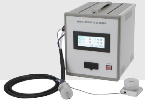
**粉末带电量分析系统212HS**是一种便携式的Q / m分析仪,利用“抽吸式”粉末转移方法提供重复性好、精度高的粉末带电量测量。由于其体积小、重量轻,该仪器非常便携,非常适合直接在生产线上或实验室中使用。它采用了一种独特的样品分离和转移技术,避免了由于与“吹飞式”测量系统相关的快速气流运动引起的测试样品意外充电而导致的测量误差。该装置配置为独立的显示器、吸入式样品池和吸入式喷嘴,以响应各种用户应用的不同配置。两个位置的开关可选择气泵强度以满足正常或高吸力应用需求,例如测量单组分碳粉的电荷(需要更强的吸力)。
