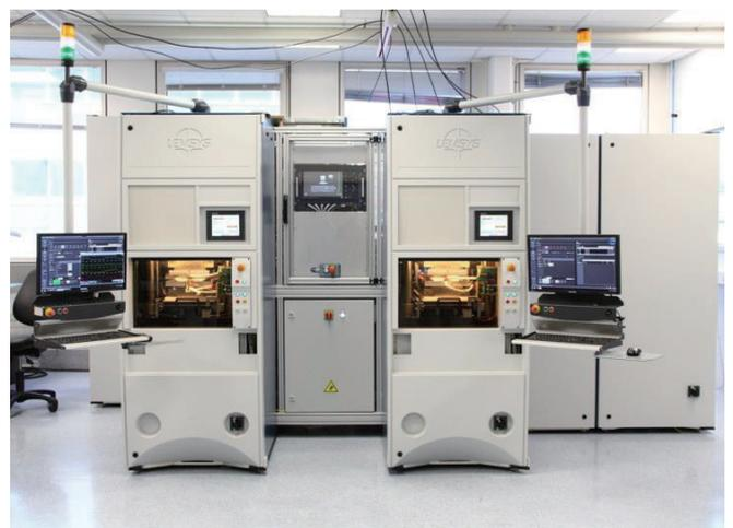
Presspack压接模块动静态测试系统
